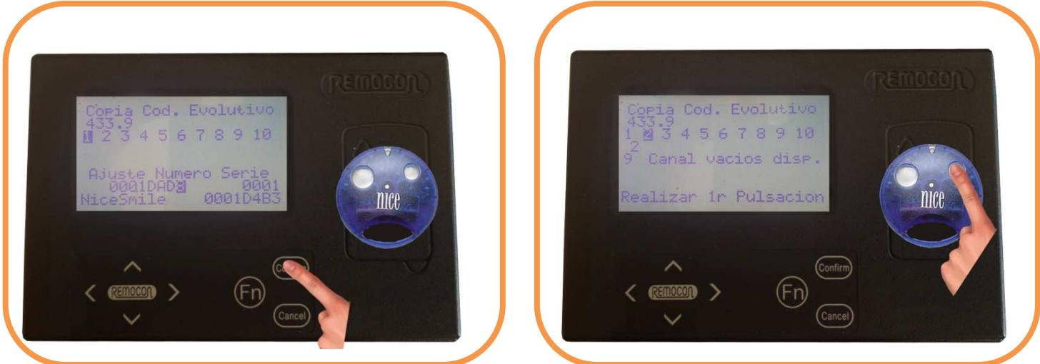
**Nota:** Es altamente recomendable descodificar el botón semilla de cualquier mando original que lo tenga en el canal número 6. Para ello una vez terminado con los botones exteriores del mando pulse flecha derecha hasta colocarse en el canal seis y pulse el botón semilla como si se tratase de un pulsador normal.
