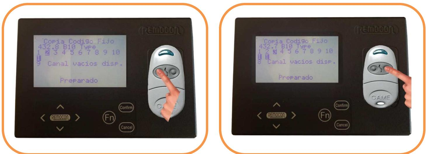
**Si se desea cambiar la frecuencia de una canal:** Para modificar la frecuencia de un canal, antes de confirmar la copia, vuelve al canal deseado con el cursor y pulse FN+>. Aparecerá en pantalla la frecuencia detectada automáticamente y podrá ser modificada con las teclas del cursor. Al finalizar pulse "Confirmar" para guardar los cambios.
