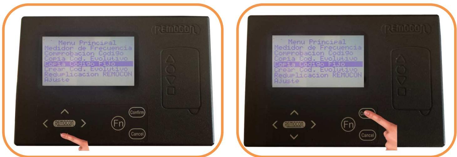
2. Apoye el mando original en la zona de lectura y pulse el botón deseado hasta escuchar un pitido, el código y la frecuencia han sido leídos. Cuando se haya almacenado en memoria el primer canal del mando el cursor se moverá automáticamente al segundo canal. De ser necesario ahora podemos leer el segundo botón del mando. Repita este proceso para cada botón que deba ser duplicado.
