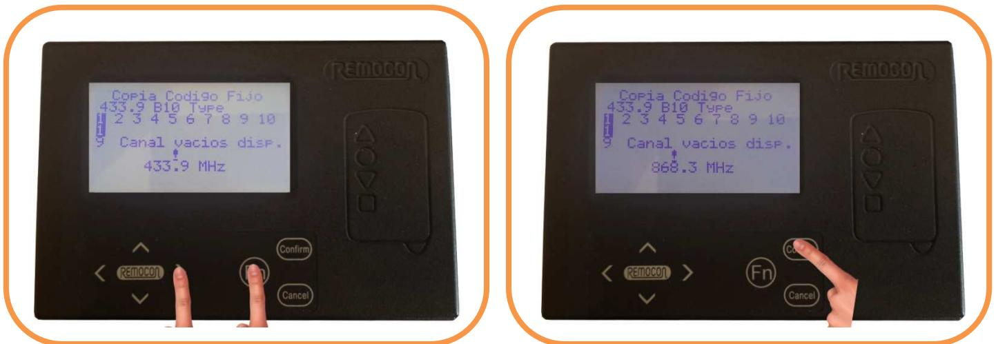
**3.** Una vez leídos todos los botones del mando original en la **HCD900** conecte el emisor **REMOCON RMC225CHM** al cable de datos y pulse
