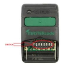
Para que su nuevo mando funcione correctamente, coloque la posición de los switch de la misma manera que están colocados los switch del mando que ya funciona o en su defecto en la misma posición que están colocados los switch receptor de su puerta de garaje o cancela.
