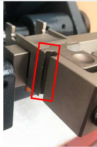
Colocación de la llave
