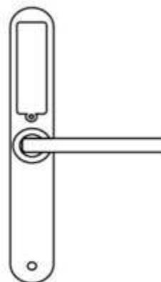
**3. Cambie la mano de la manilla insertándola en su alojamiento y coloque los dos tornillos retirados en el paso 1.**
