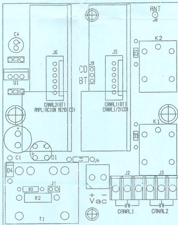
La RXFbase es una base para la conexión de Receptores Enchufables con conectores de 6 Pin de los modelos Binario, Trinario y Código Dinámico permitiendo a estos que funcionen como Receptores independientes Monocanales ó Bicanales alimentados a 220 Vac.
